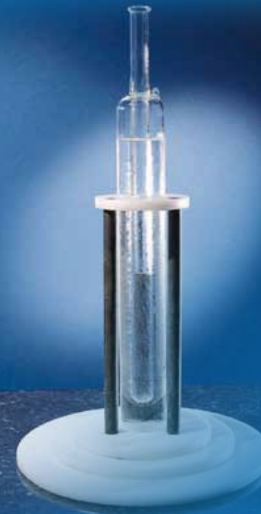
Bildet viser en trippelpunktcelle for vann, der is, vann og mettet vanddamp er i likevekt, noe som gir en temperatur på nøyaktig + 0,01°C.
