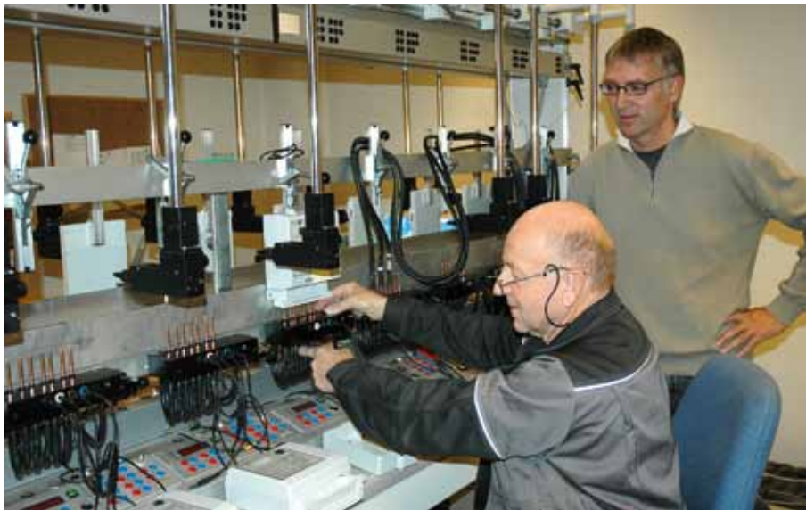
Thor Eggen kopler opp en el-måler for test i Istas målerlaboratorium, mens Arvid Aunrønning følger med.
