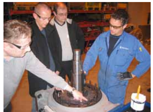
Kursdeltakere hos Rolls Royce i Brattvåg analyserer en delvis sammenstilt vinsjmotor.
